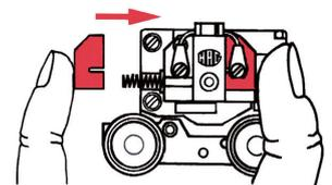
Beim montieren des Motorkastens ist darauf zu achten, dass die Verbindungskabel nicht eingeklemmt werden.
